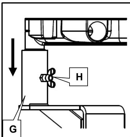
Kapsaven monteres i maskinfremføreren ved hjælp af den forreste styrerulle.
