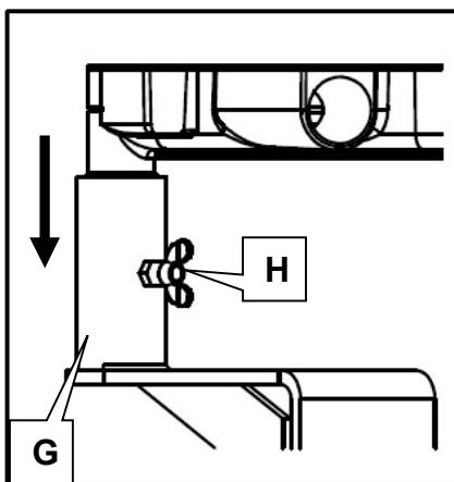
Das Trennsystem wird über die vordere Führungsrolle mit der Vorschubeinheit verbunden.
