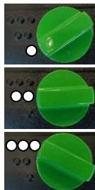
Die **PLD 182.1 NT** besitzt ein 3-Gang-Ölbadgetriebe. Passen Sie die Drehzahl dem Bohrdurchmesser an. Drehen Sie den Getriebeschalter soweit in den schnelleren bzw. langsameren Gang, bis dieser einrastet. Lässt sich die Maschine nicht schalten, ist durch leichtes Verdrehen der Arbeitsspindel der Schaltvorgang zu unterstützen.
