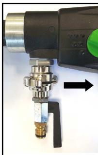
Anbring adapteren med kugleventilen på maskinens tilslutning og drej den i pilens retning for fastlåsning. Tilslut maskinen til en vandforsyning eller en vandtrykbeholder via koblingen.
