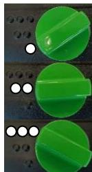
PLD 182.1 NT har en 3-trins oliebads gearkasse. Juster hastigheden efter borets diameter.
