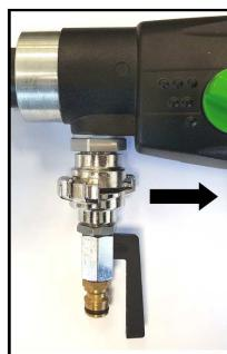
Plaats de adapter met de kogelklep op de connector van het apparaat en draai in de richting van de pijl totdat deze stopt. Sluit het apparaat aan op de watertoevoer of drukvat met behulp van de drukklep.
