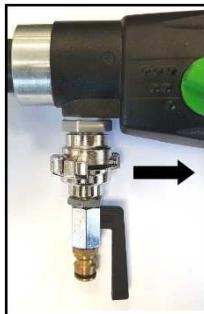
Inserite l'adattatore con il rubinetto a sfera sul collegamento della macchina e giratelo in direzione della freccia fino al punto di arresto. Collegate la macchina alla rete idrica o ad un recipiente a pressione idraulica mediante l'attacco.
