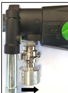
Beim Arbeiten entstehender Staub ist gesundheitsschädlich. Bei Trockenbohrungen ist deshalb ein Staubsauger zu verwenden und eine Staubschutzmaske zu tragen. Setzen Sie den Adapter für die Staubabsaugung auf den Anschluss der Maschine und drehen Sie ihn in Pfeilrichtung gegen den Anschlag.
