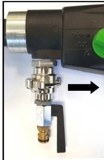
Setzen Sie den Adapter mit dem Kugelhahn auf den Anschluss der Maschine auf und drehen Sie ihn in Pfeilrichtung gegen den Anschlag. Schließen Sie die Maschine über das Stecknippel an die Wasserversorgung oder ein Wasserdruckgefäß an.
