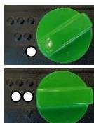
De **PLD 182.1 NT** is voorzien van een mechanische 3-versnellingen transmissie in olie. Pas de rotatiesnelheid van de motor aan de boordiameter aan (kijk op de type plaatje voor details). Zet de versnellingsschakelaar op een hogere of lagere versnelling tot de aanslag. Versnellingen mogen alleen veranderd worden tijdens stilstand van de motor. Bij haperingen bij het overschakelen kan het nodig zijn de boor lichtjes te draaien.
