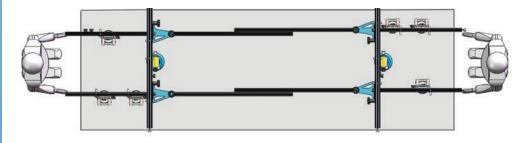
Sugekoppernes placering til løft af tynde plader, maksimal kapacitet 150 kg.
