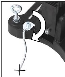
Zaznaczyć środek wykonywanego otworu. Odchylić wskaźnik środka otworu do oporu (patrz rys).
