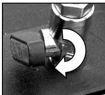
Pour débrancher la connexion de vide, refermez la valve. Cela ouvre une soupape de décharge permettant au vide de s'échapper. Ainsi, le système peut être activé lorsque la pompe à vide est en marche si nécessaire.
