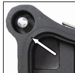
Beachten Sie bitte, dass die Nivellierschrauben so eingestellt sind, dass sie nicht aus der Unterseite des Bohrständerverfüßes herausragen, da sonst das Vakuum beeinflusst wird und der Ständer sich vom Untergrund lösen kann.
