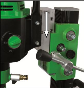
Die Montageplatte wird mit der Passfeder so auf die Maschine aufgesetzt, dass sich die Buchsen in der Montageplatte auf der gleichen Seite befinden wie die Getriebeumschaltung der Maschine. Danach werden die vier Schrauben eingesetzt und fest angezogen.
