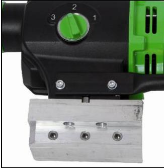
Fahren Sie den Maschinenhalter so weit nach oben, bis dieser in der Endlage einrastet.
