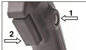
Zur Inbetriebnahme des Elektrowerkzeugs betätigen Sie zuerst die Einschaltsperrre (1), drücken anschließend den Ein-/Ausschalter (2) und halten ihn gedrückt.
