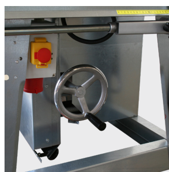
Drejehjul - Justering af skæredybde
